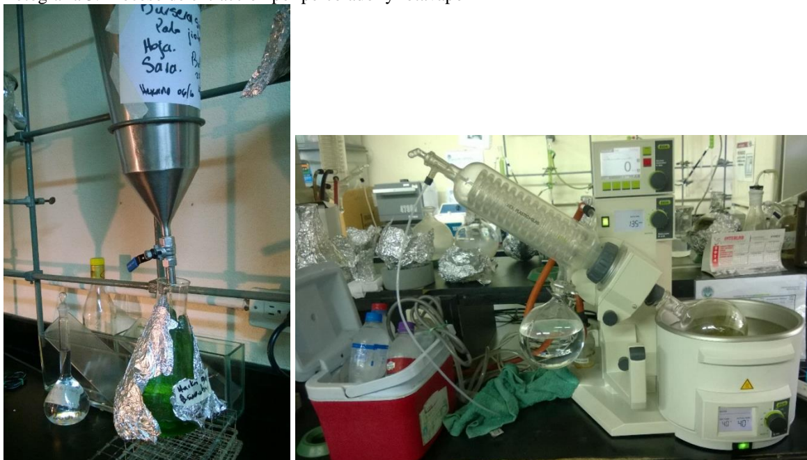
Fotografía 3. Proceso de extracción por percolador y rotavapor
