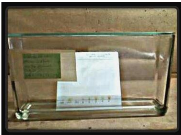
Cámara cromatográfica compuesta por una fase móvil (acetona/metanol 1:49) y una fase sólida (placa de sílica gel), cargada con los extractos vegetales metanólicos a evaluar. Laboratorio de Investigación de Productos Naturales (LIPRONAT), USAC.
