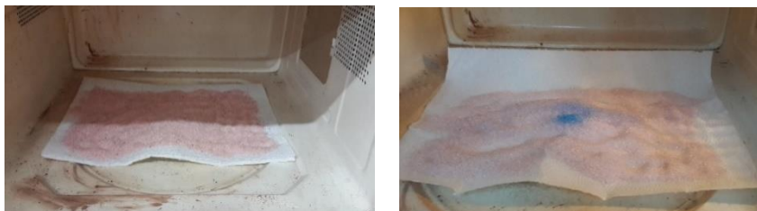
Serie de Imágenes 18: Determinación del área más caliente del horno microondas
