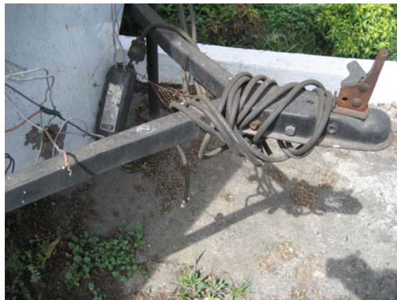
Figura #8. En esta Imagen se puede observar el sistema utilizado para remolcar el Laboratorio Móvil de un lugar a otro, el cual necesita de un automóvil de gran potencia, debido a su excesivo peso.
