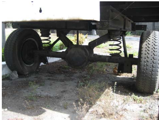
Figura #6. Imagen del sistema de amortiguamiento, soporte del equipo. En esta imagen se puede observar que el sistema de resortes no cuenta con las barras estabilizadoras, que son las necesarias para que el cajón sea estable en las curvas. También se deja ver que no cuenta con hojas de resorte ni amortiguadores, los cuales evitan que salte el cajón al momento de pasar por algún bache. Todos estos factores mencionados anteriormente hacen de este laboratorio un sistema peligroso.
